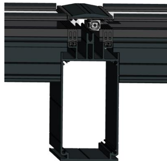
Montant 142mm Moment d'inertie : 281 cm 4
