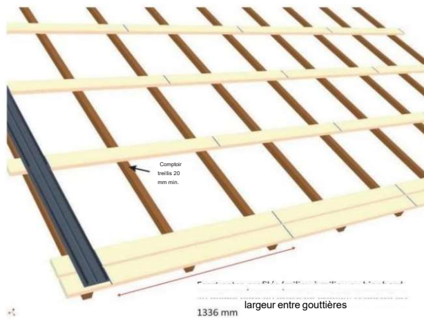
Fig. 2 Position des rainures de gouttière (bleu avec corde à tracer)
