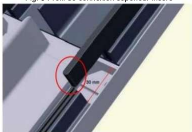
Fig. 3 Profil de connexion supérieur inséré
